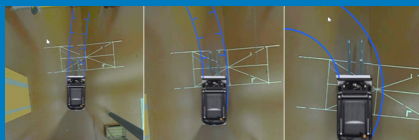
Automatische Zoom-Funktion, um langsame Manöver in beengten Umgebungen zu vereinfachen
