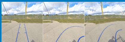
Digitales Schwenken der Kamera abhängig vom Lenkwinkel, ermöglicht dem Fahrer mehr des relevanten Bereichs zu überblicken
